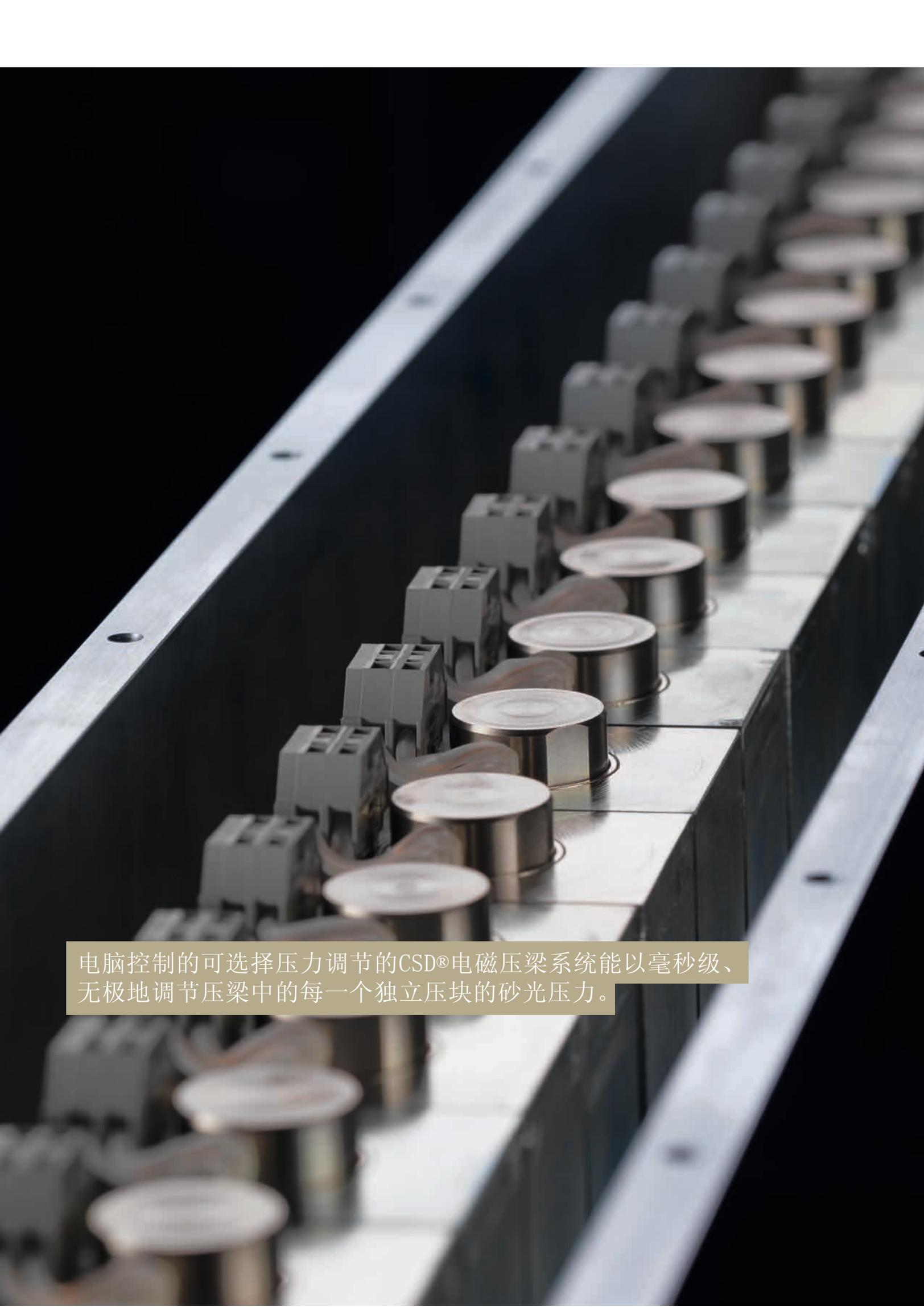
电脑控制的可选择压力调节的CSD®电磁压梁系统能以毫秒级、无极地调节压梁中的每一个独立压块的砂光压力。
