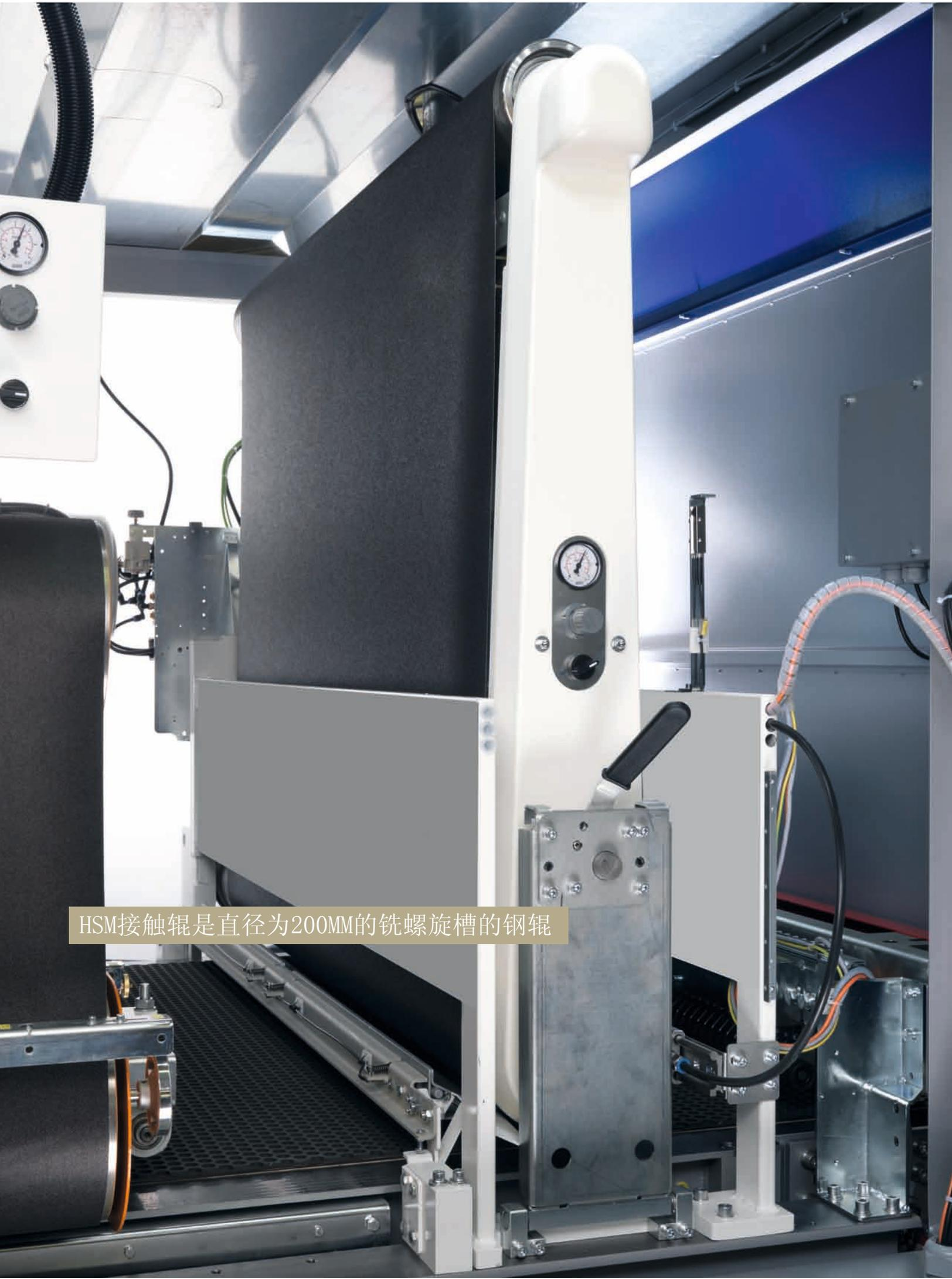
HSM接触辊是直径为200MM的铣螺旋槽的钢辊
