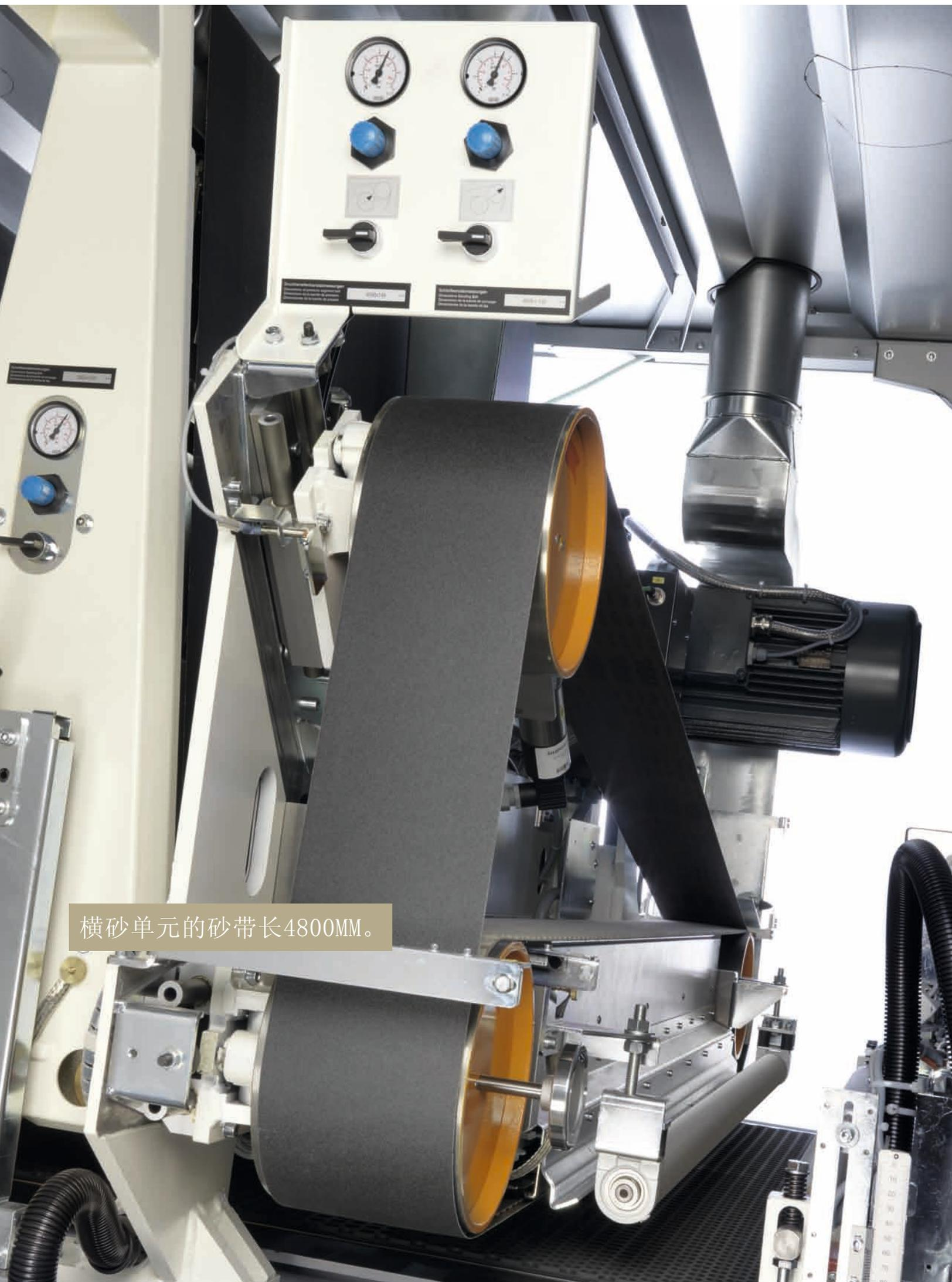
横砂单元的砂带长4800MM。
